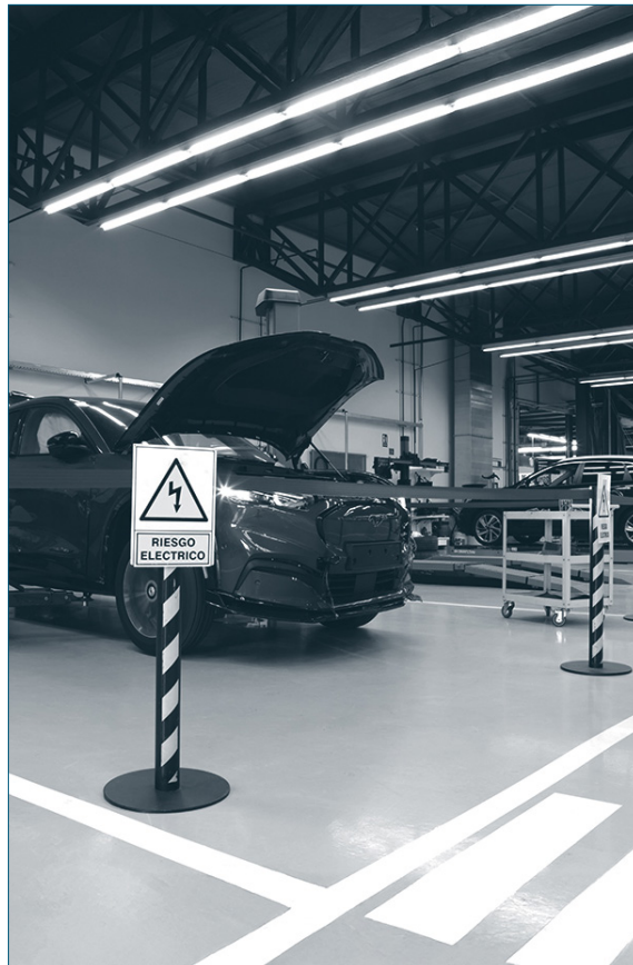
Imagen 4. Zona señalizada en taller para la reparación de un vehículo eléctrico.
